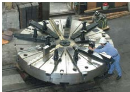
国内最大級外径「φ3,500ミリ」の大型チャック 建設機械産業・エネルギー産業・航空宇宙産業などに使われています。
